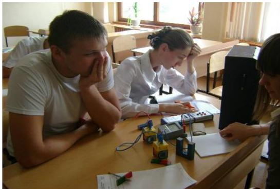
При изучении зависимости сопротивления проводников от его геометрических размеров демонстрируем прямую зависимость сопротивления от длины. Можно эту работу предложить на физическом практикуме: «Определить, из какого материала изготовлен проводник» или «Определить длину проводника», или «Определить площадь поперечного сечения проводника». Для этого снимаются показания амперметра и вольтметра, определяется длина проводника, вычисляется площадь поперечного сечения, измерив, диаметр.
